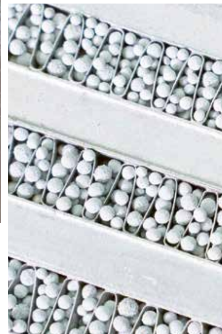
Zeolith-Granulat kann als Langzeit-Wärmespeicher dienen.
