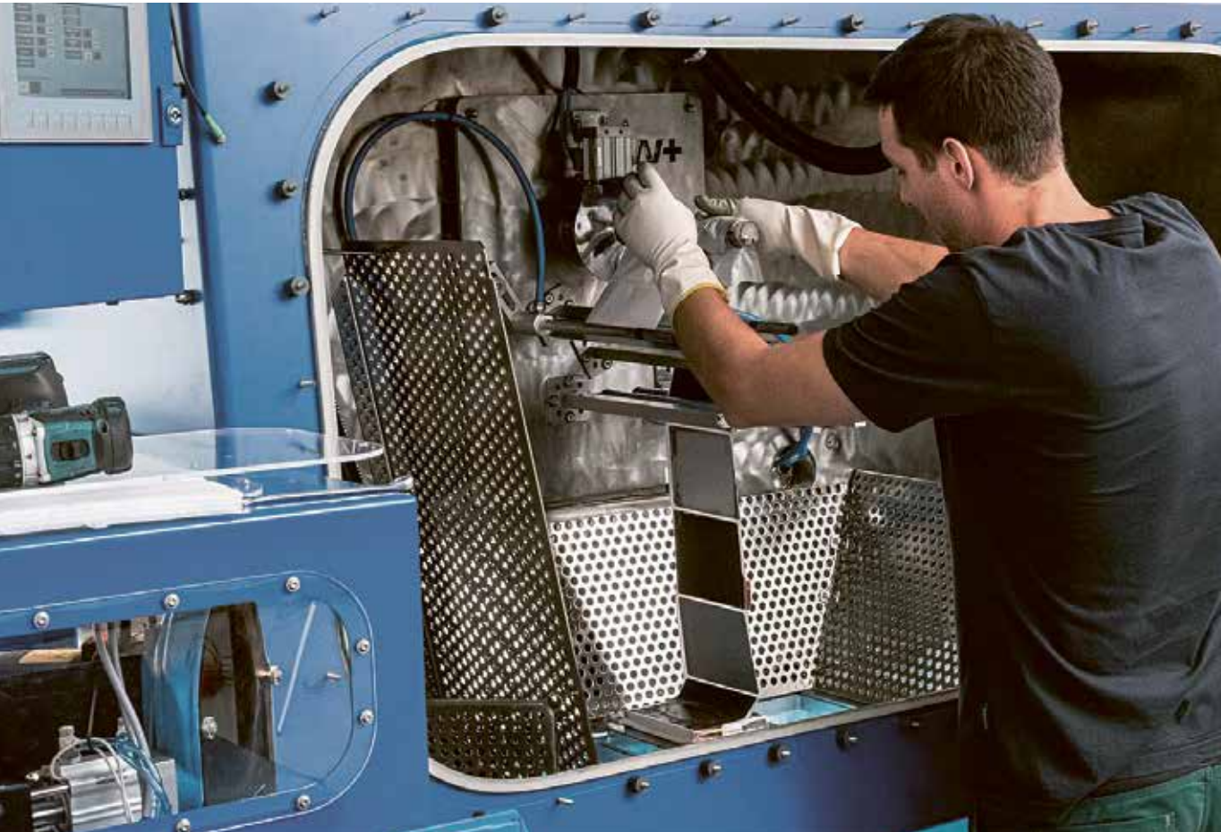
Das von der Empa und der Kyburz Switzerland AG entwickelte Recycling alter Fahrzeugbatterien setzt auf Zerlegen statt auf Schreddern.
