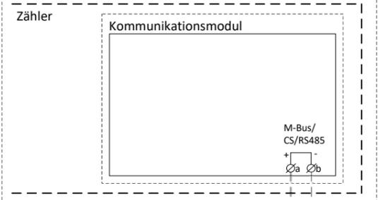
Zwingend TP-Kabel oder Draht min. 0.6mm<sup>2</sup> verwenden
